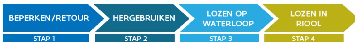
Figuur 91: Stappen in mogelijkheden bemaling van grondwater (VMM, sd)
