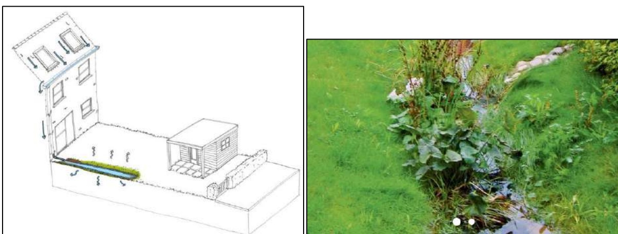
Figuur 74: Regenwater naar infiltratiegracht (AquaFin, Vlario, sd)
