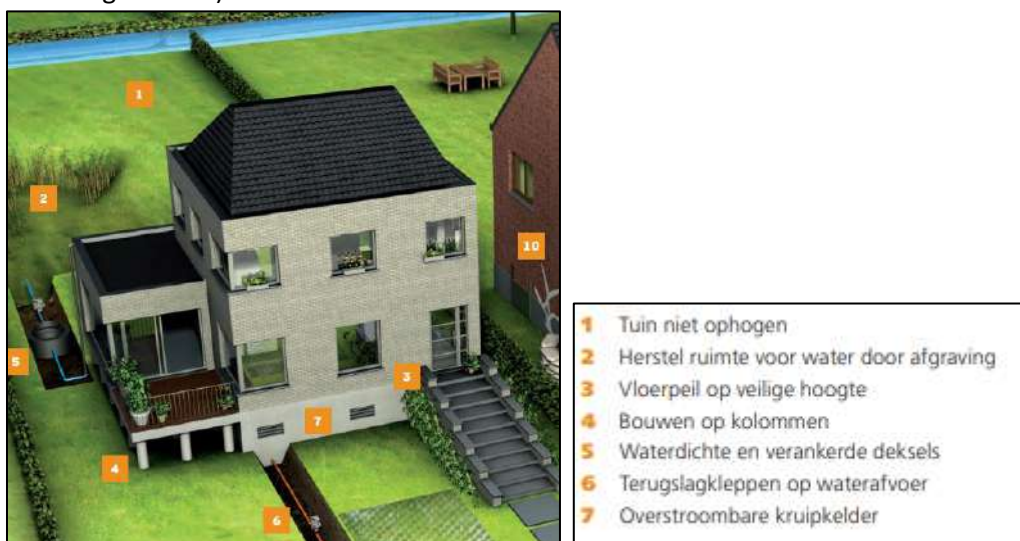
Figuur 87: Overstromingsgevoelig bouwen bij een nieuwe woning (Integraal Waterbeleid, 2011)
